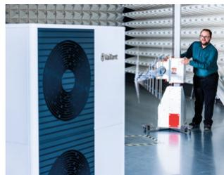
La cámara electromagnética comprueba la compatibilidad con otros sistemas de tu hogar
