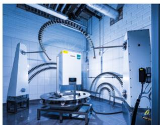
Los test de lluvia y viento verifican que el equipo sea resistente a la corrosión
